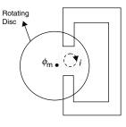
Braking torque,  $T_{\rm B} \alpha (N\phi_{\rm M}) Id$
