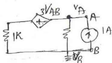
$$\frac{V_A + 3V_{AB}}{2k} + \frac{V_A}{1k} = 1$$
