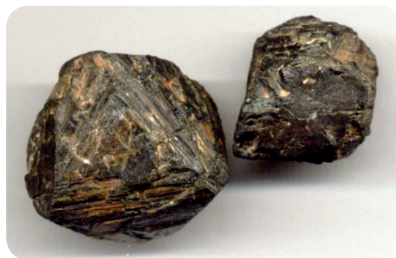
Fig. 5.45 : Uneven fracture in Magnetite
