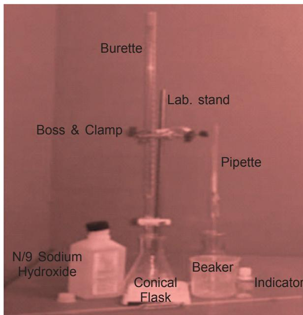
Fig.1.1. Titratable acidity apparatus
