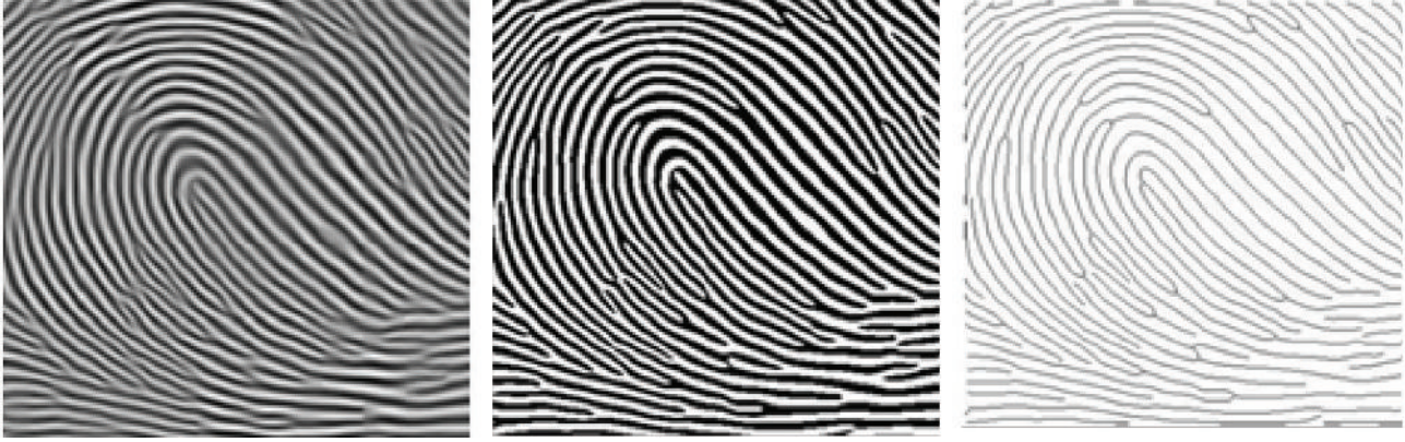
படம் 6.8 அங்க அடையாளமான கைரேகை பிம்பத்தில் பயன்படும் இருமயமாக்கல் (binarization) மற்றும் சன்னமாக்குதல் (thinning)
