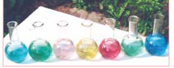
આકૃતિ 8.5 : પ્રથમ શ્રેણીના કેટલાક ધાતુ આયનોના જલીય દ્રાવણોના રંગ, ડાબીથી જમણી બાજુ તરફ : V^{4+} , V^{3+} , Mn^{2+} , Fe^{3+} , Co^{2+} , Ni^{2+} અને Cu^{2+}
