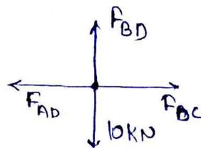
$F_{BD} = 10 \text{ kN (tensile)}$
