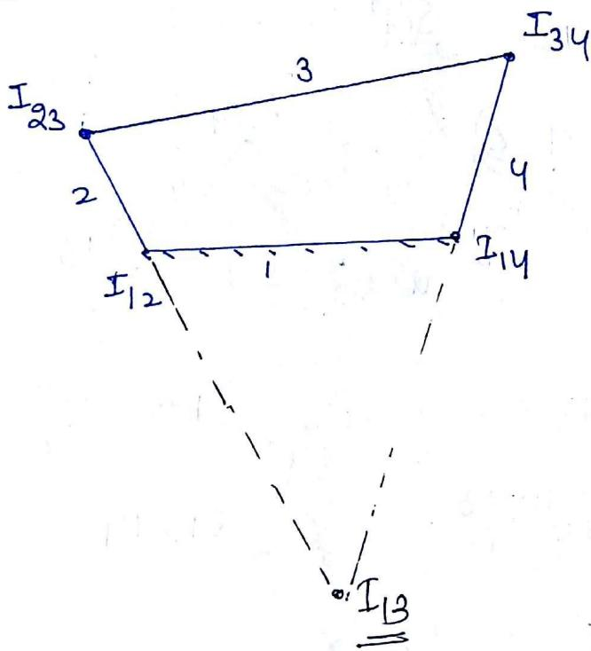
$$\vec{\omega}_{g3} = \vec{\omega}_g - \vec{\omega}_3$$
