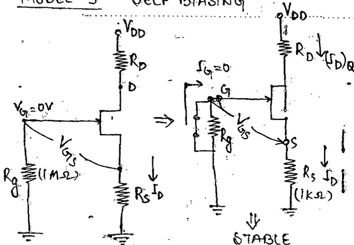
$$V_{G1} = V_{GS} + I_D R_S$$
