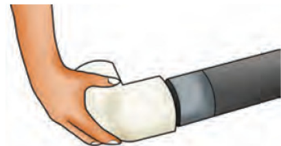
चित्र 1.12 : जब सीमेंट विलायक (solvent) गीला हो तभी किनारों को
