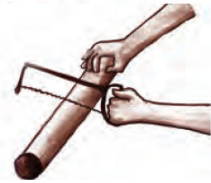
चित्र 1.10 : पाइप के किनारों को काटें और साफ करें
