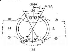
Demagnetizing armature mmf per pole.
