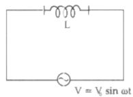
$$\therefore di = rac{V_0}{L} \sin \omega t dt$$
