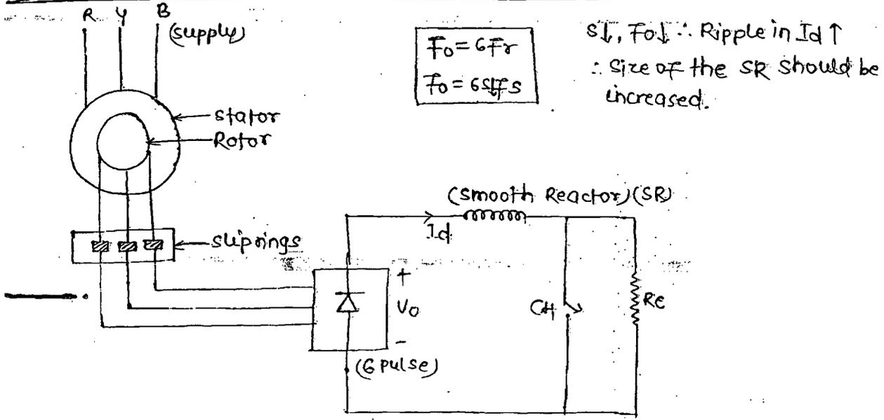
$$\text{Total cu loss} = 3I_r^2 R_r + I_d^2 (1-\alpha) R_e$$
