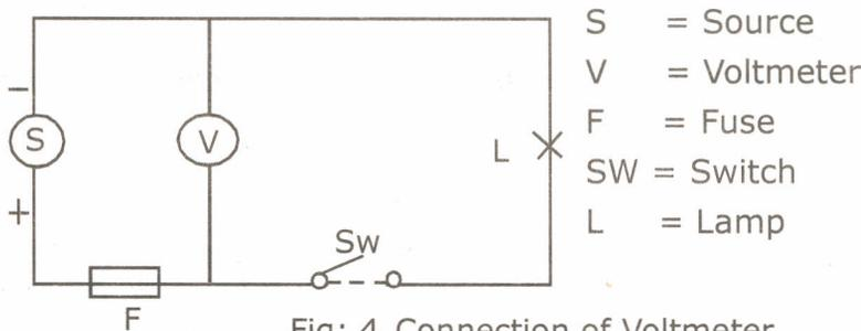
Fig: 4 Connection of Voltmeter
