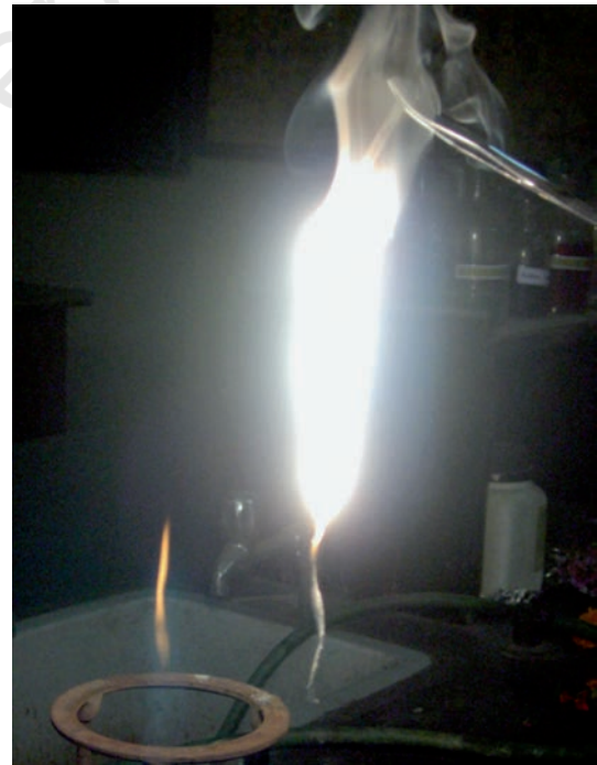
شکل 6.3 جلتا ہوا میگنیشیم ربن
