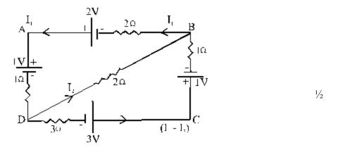
$$\begin{array}{l} -2I_{_1}+2-1-1x\ I_{_1}-2I_{_2}=0 \quad \text{or} \quad 3\ I_{_1}+2\ I_{_2}=1.: \\ \text{and,} \quad -3(I_{_1}-I_{_2})+3-1-1\ x\ (I_{_1}-I_{_2})+2\ I_{_2}=0 \quad \text{or} \ 4\ I_{_1}-6\ I_{_1}=2 \end{array}$$
