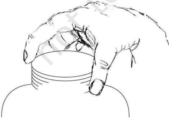
شکل (a) 7.21 ہماری انگلیاں ڈھکن کو گھمانے پر جفت فراہم کرتی ہیں۔
